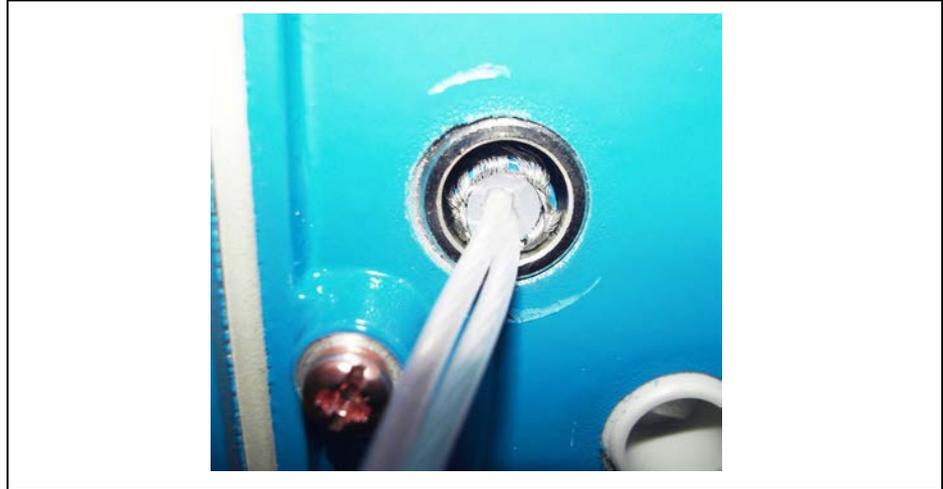
**Abb. 5-23** Eingeführtes Sensorkabel Innenansicht
