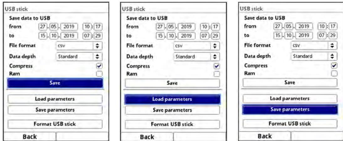
**Fig. 33-8 Save/load parameters**
